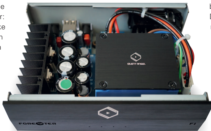
AUFGESCHRAUBT: Im Forester F1 wirken ein Ringkerntrafo, Siebkondensatoren und Transistoren.
