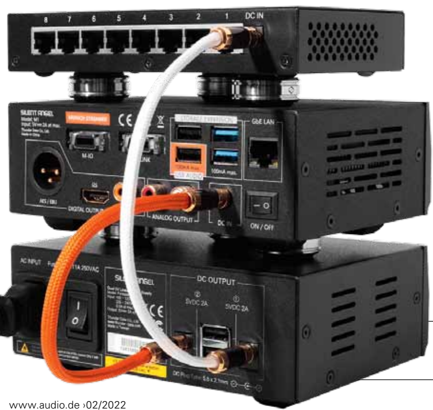
GUT VERSORGT: Das Netzteil Forester F1 (unten) beliefert Switch und Streamer.
